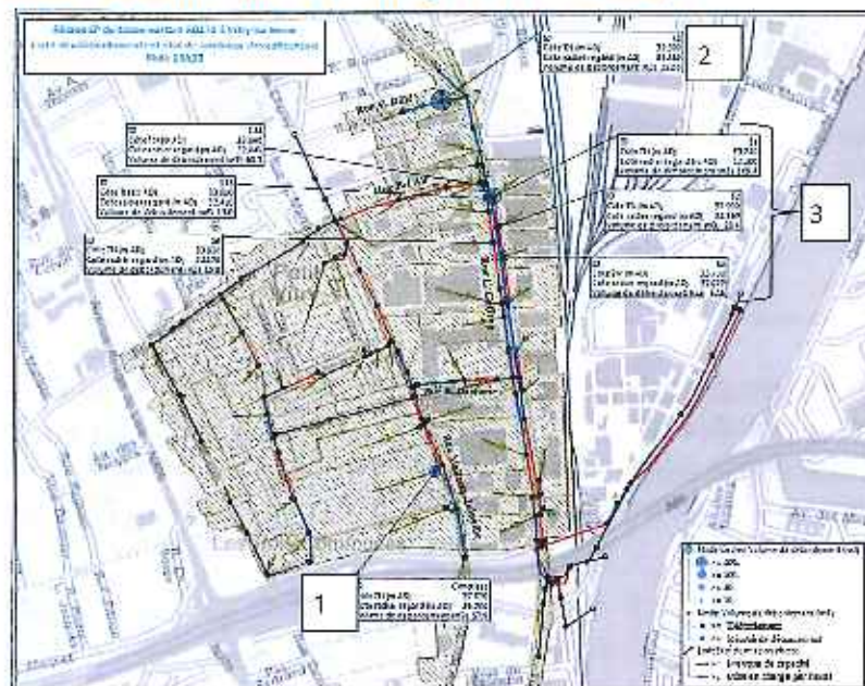
Cartographie des débordements en situation actuelle du réseau EP du bassin versant de la RD274 pour une pluie décennale
